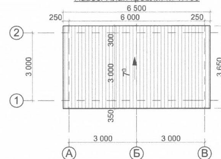
Навес. План кровли. М 1:100
